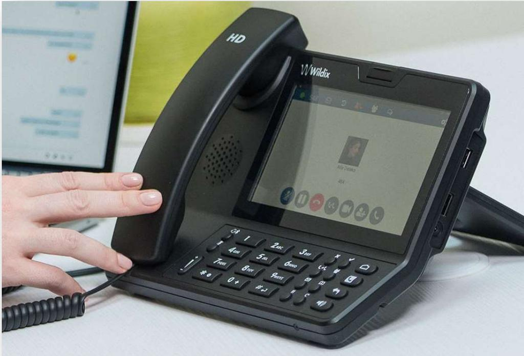
**Vision est un appareil Android, compatible WebRTC**, qui est équipé d'un écran de 7 " et d'une webcam de 2 mégapixels, parfait pour les appels vidéos et la visioconférence.
